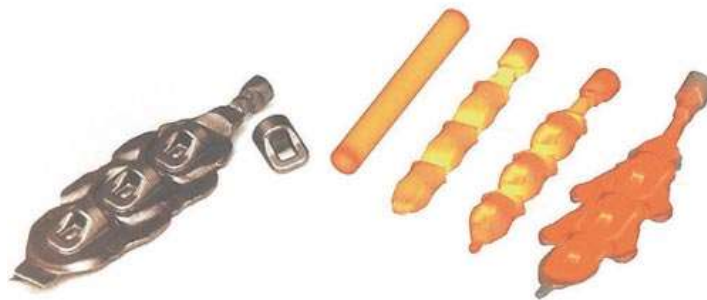
Рисунок 1.3. Проушины баллона для сжатого воздуха
