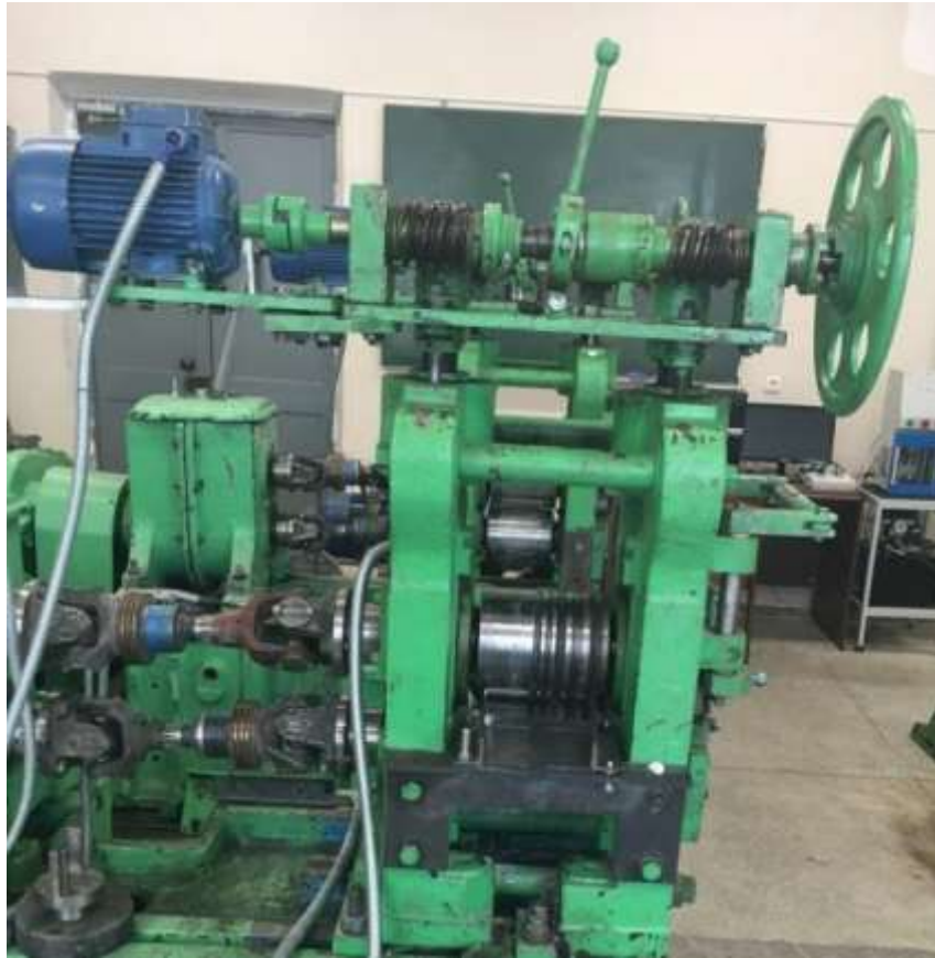
Рисунок 2.2. Общий вид прокатной клетки
