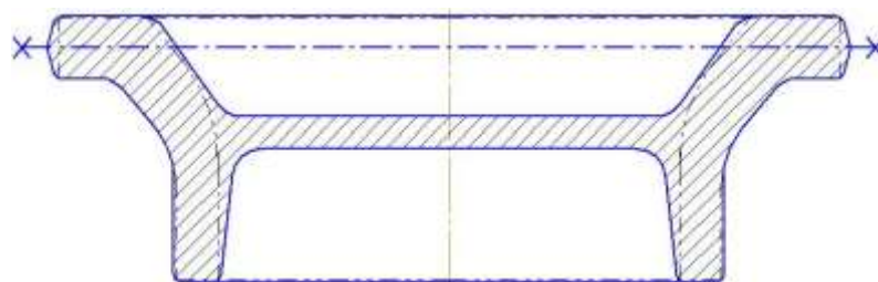
Рисунок 2 – Схема плоскости разъема штампа
