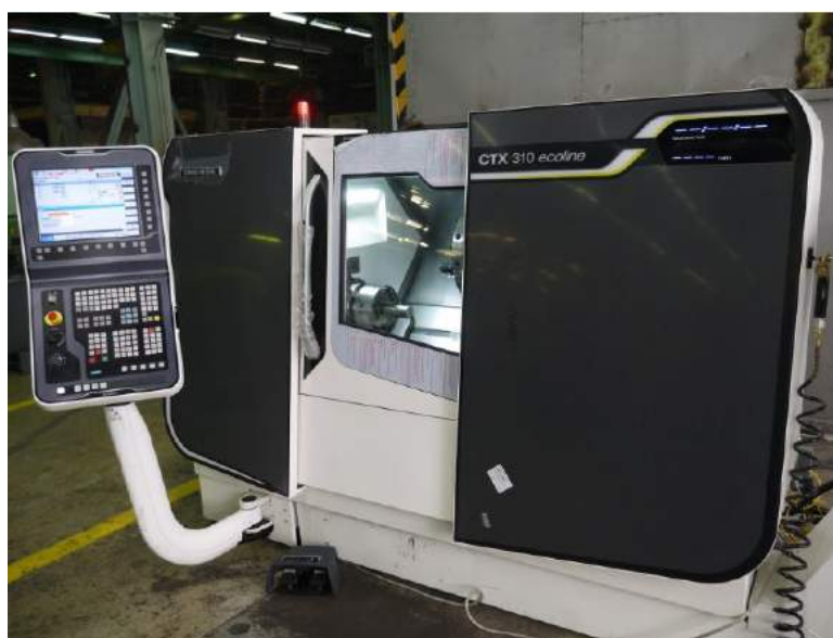
Рисунок 28 – Токарный станок DMG STX310 ecoline
