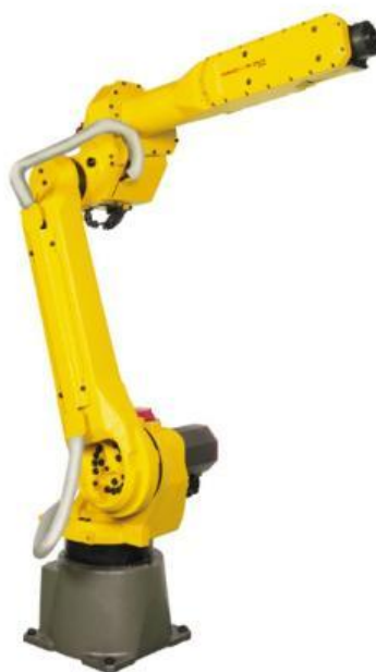
Рисунок 8 – Робот-манипулятор Fanuc M-710iC
