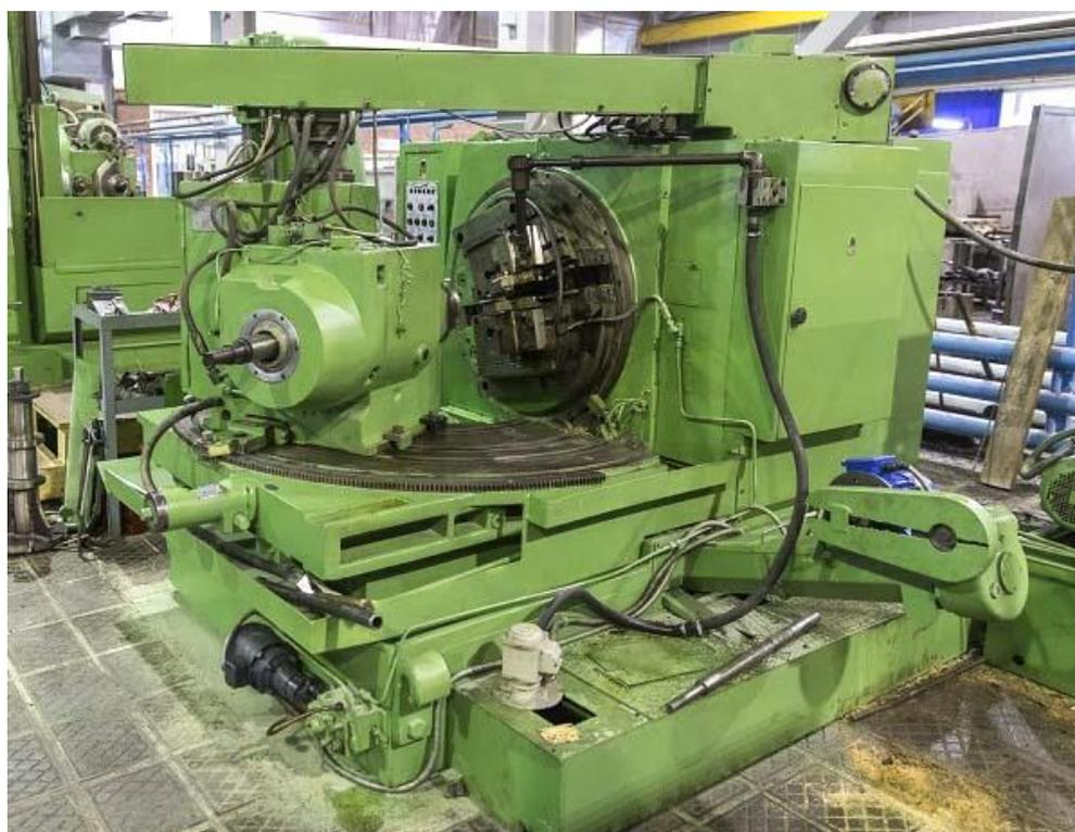
Рисунок 2.24 – Зубострогальный станок 5С276П
