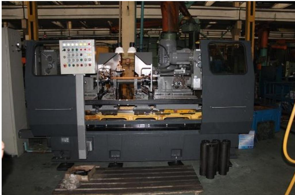
Рисунок 2.22 – Фрезерно - центrovально - обточной станок 2Г942
