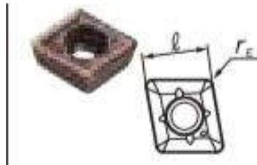
Рисунок 3.22– Пластина Sumitomo для сверла
