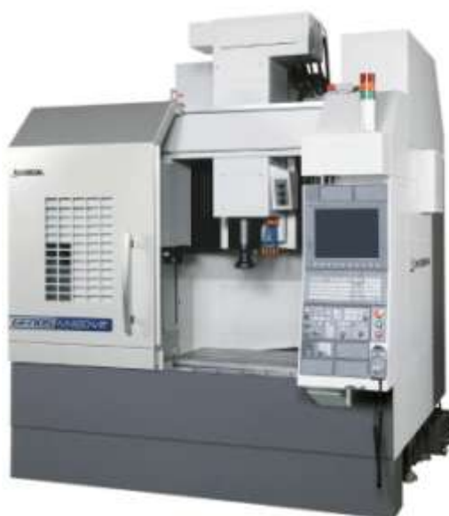
Рисунок 2.10 – Вертикально-фрезерный станок с ЧПУ OKUMA Genos M460R-VR
