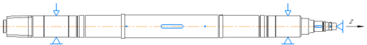
Рисунок 3.9 – Схема базирования детали при фрезеровании
