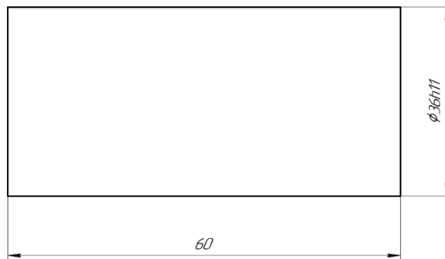
Рисунок 2.5 – Операционный эскиз 005 отрезная операция
