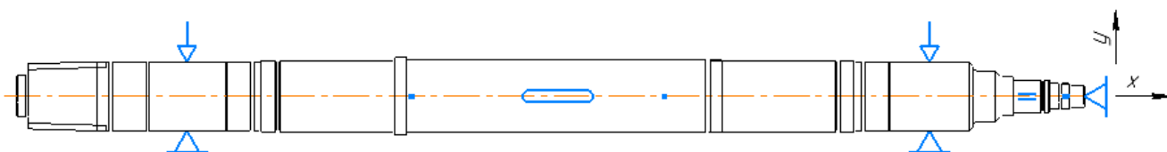
Рисунок 14 –Схема базирования детали при фрезеровании (Операция 45, установ 2)
