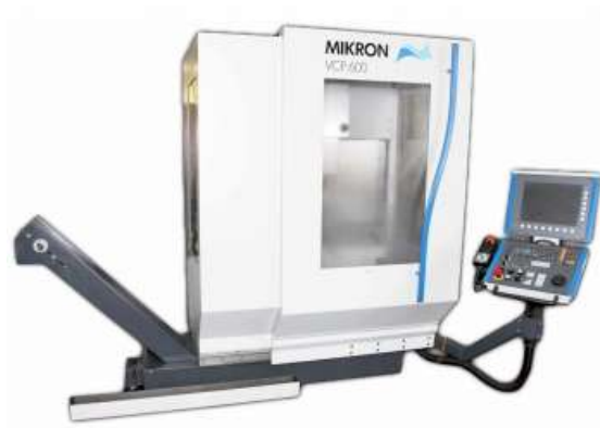
Рисунок 2.2.2.2 – Многоосевой обрабатывающий центр UCP600
