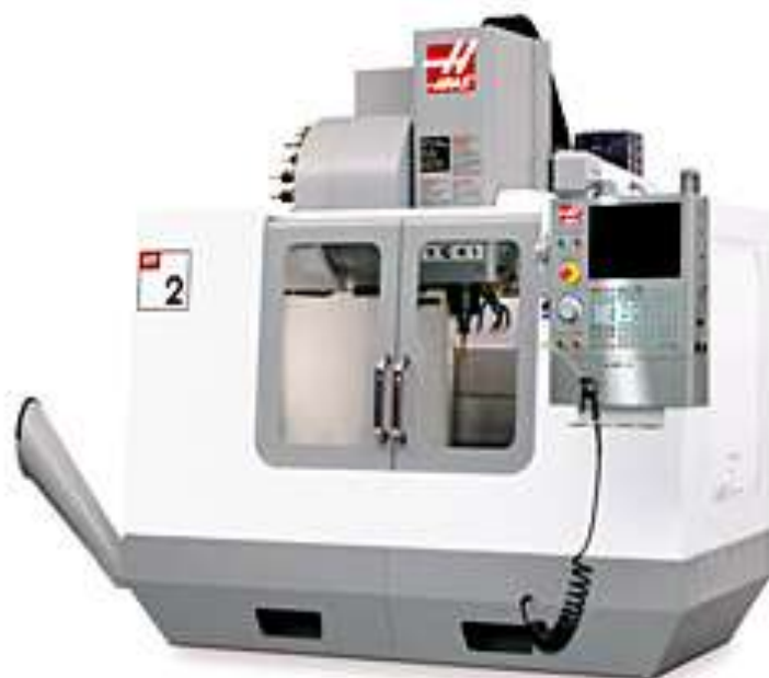
Рисунок 2.9 – Вертикально-фрезерный центр с ЧПУ HAAS VF-2BHE
