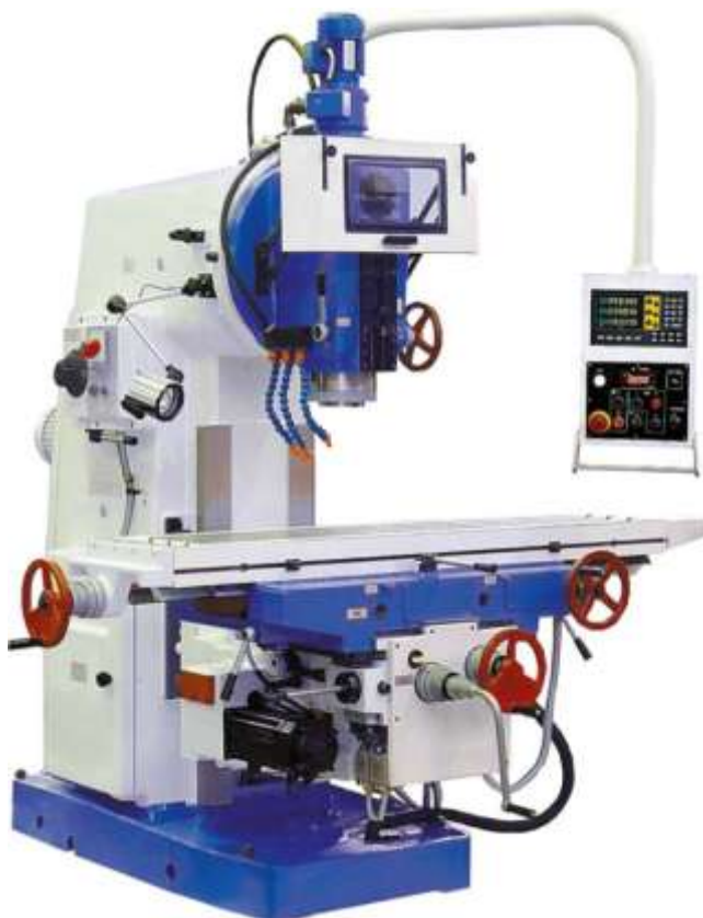
Рисунок 2.7 – Вертикально-фрезерный консольный станок VM127M
