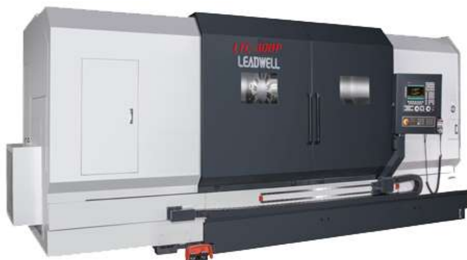
Рисунок 2.8 – Токарно-револьверный центр с ЧПУ LTC-30BP
