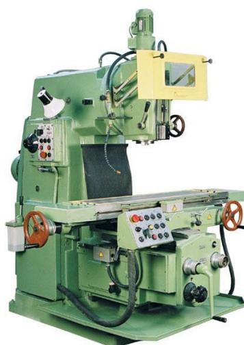
Рисунок 2.7 – Фрезерный станок 6P13
