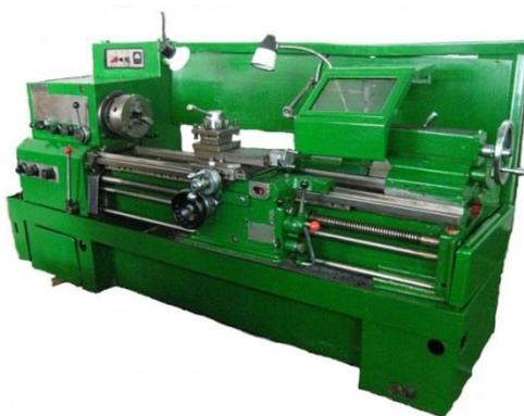
Рисунок 2.6 – Токарный станок 16К20
