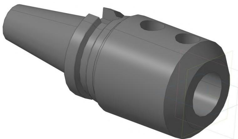
Рисунок 3.15 – 3d модель оправки MAS403BT Weldon H 90 D32 ISO40
