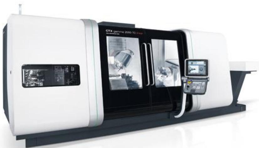
Рисунок 2.24 – Токарно-фрезерный станок с ЧПУ DMG CTX gamma 2000 TC
