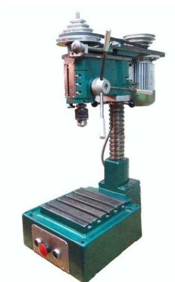
Рисунок 2.8 – Сверлильный станок 2M112
