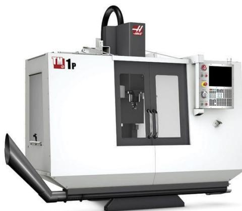
Рисунок 3.4 – Фрезерный станок с ЧПУ HAAS TM-1
