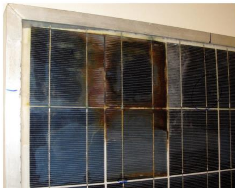
Рис. 3.3. Стекло-стеклянный модуль со специфическим типом герметика иономера, который, как оказалось, имеет недостаточную адгезию, показывая расслоение и коррозию.
