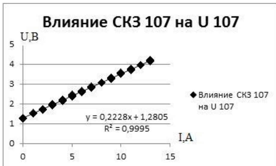
Рисунок 2.2 – Влияние станции катодной защиты расположенной на 107 километре на суммарный потенциал в точке дренажа
