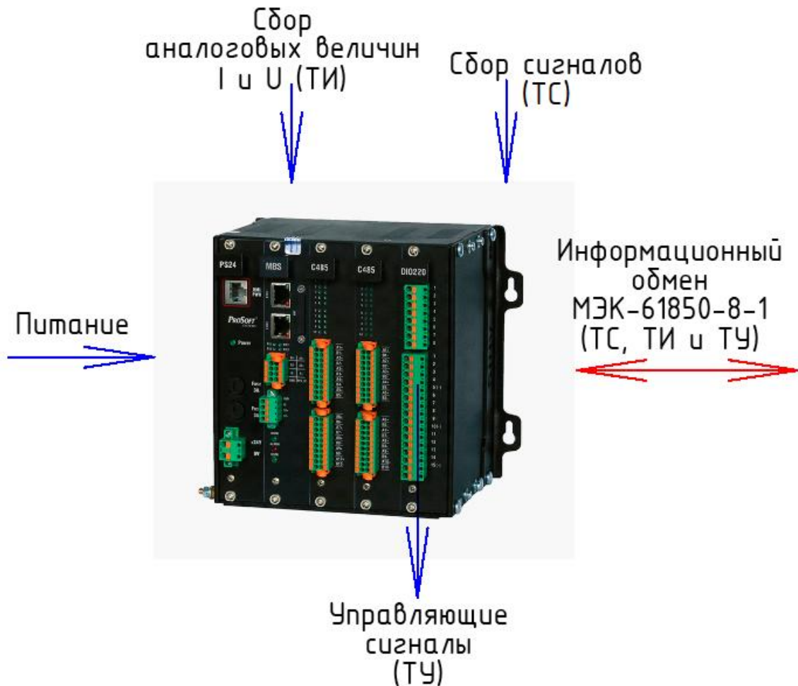
Рисунок 3.12 – Внешний вид контроллера присоединения 10 кВ с платами
