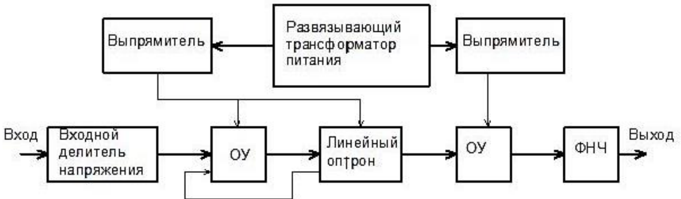
Рисунок 2.1. – Структурная схема изолирующего усилителя: ОУ – операционный усилитель; ФНЧ – фильтр низких частот
