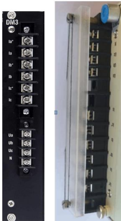
Рисунок 3.13 – Общий вид модуля прямого ввода ЗТТ, ЗТН аналогового сигнала
