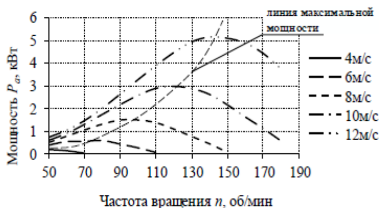
Рисунок 1.9 — Зависимость генерируемой мощности от частоты вращения ветроколеса для разных скоростей ветрового потока
