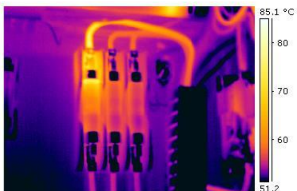
Рисунок 1. Распределение температуры на экране тепловизора
