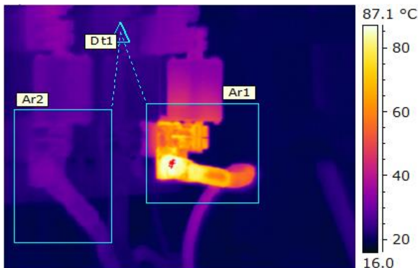
Рисунок 9. Термограмма оборудования ТП-1143 РУ 0,4кВ 1С гр.3 фазы «С».
