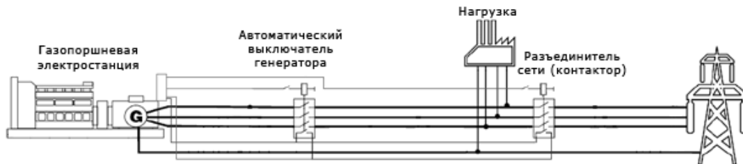
Рисунок – 4 Схема подключения газопоршневого агрегата в качестве аварийного источника электроэнергии
