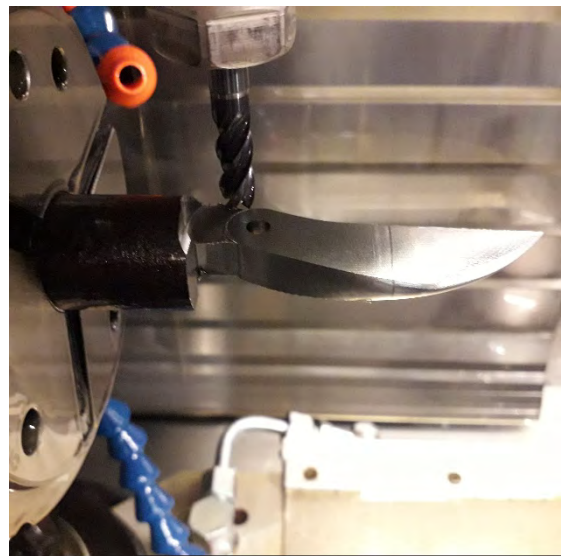
Рисунок 2.11 – Чистовое фрезерование оставшейся второй части поверхности
