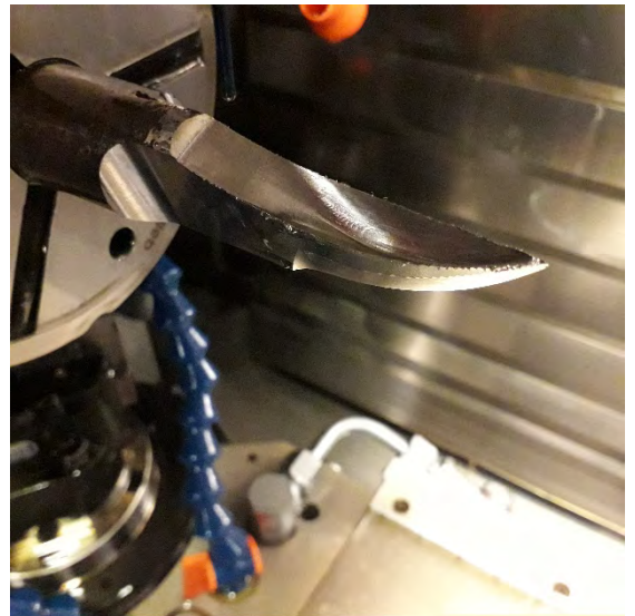
Рисунок 2.6 – Чистовое фрезерование внутренней линейчатой поверхности детали сферической фрезой \varnothing 2 мм ( r = 1 мм)
