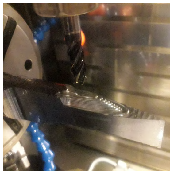
Рисунок 2.4 – Черновое фрезерование выпуклой части наружной поверхности с поворотом заготовки на 180^\circ на \frac{1}{2} ее длины
