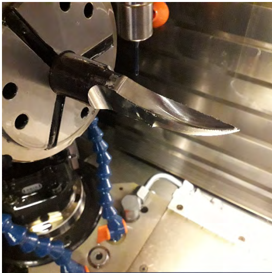
Рисунок 2.6 – Чистовое фрезерование внутренней линейчатой поверхности детали сферической фрезой \varnothing 2 мм ( r = 1 мм)
