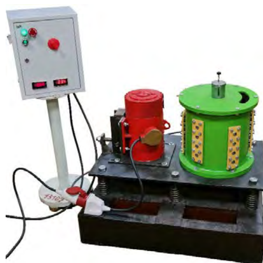
Рисунок 3.1 – Экспериментальная дробилка для управляемого размерного диспергирования коллагенсодержащих сред
