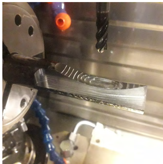
Рисунок 2.3 – Черновое фрезерование вогнутой наружной поверхности детали на \frac{1}{2} длины заготовки
