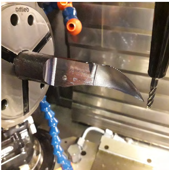
Рисунок 2.8 – Чистовая обработка наружной (выпуклой) поверхности детали
