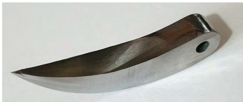
Рисунок 4.1 – Инструмент («коготь») ударно-режущего действия для вибрационной молотковой дробилки
