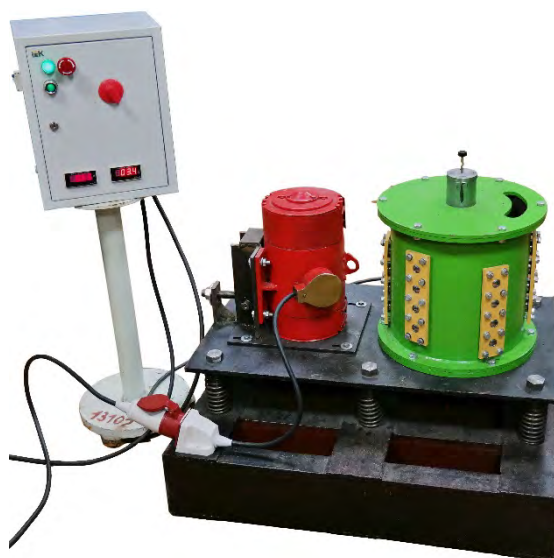
Рисунок 4.2 – Экспериментальная дробилка для управляемого размерного диспергирования коллагенсодержащих сред
