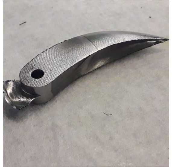
Рисунок 2.12 – Отрезка готовой детали «кошачий коготь»
