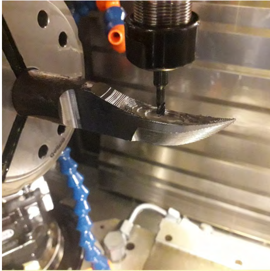
Рисунок 2.5 – Получистовое фрезерование внутренней линейчатой поверхности детали сферической фрезой \varnothing 4 мм ( r = 2 мм)
