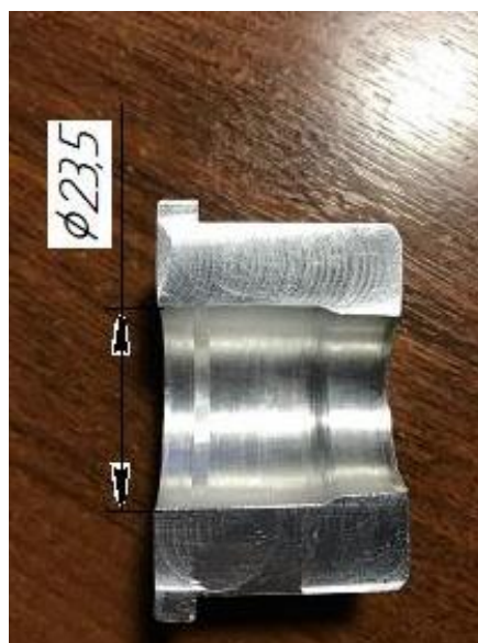
Рисунок 2.4 – Заготовка обработанная ружейным зенкером после второй переточки
