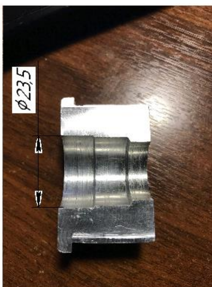
Рисунок 2.2 – Заготовка обработанная ружейным зенкером до переточки
