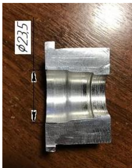
Рисунок 2.3 – Заготовка обработанная ружейным зенкером после первой переточки
