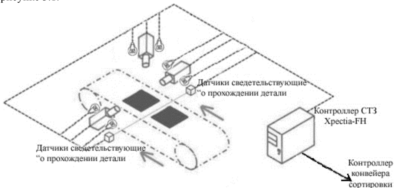
Рисунок 3.1 - Упрощенная графическая схема СТЗ контроля геометрических параметров керамической плитки, за исключением «системы сортировки»
