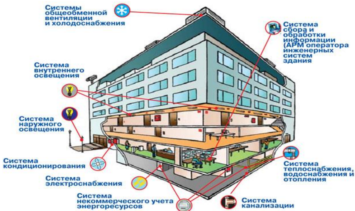
Рисунок 2- Пример структурной схемы построения автоматизированной системы учёта и диспетчеризации энергоресурсов.
