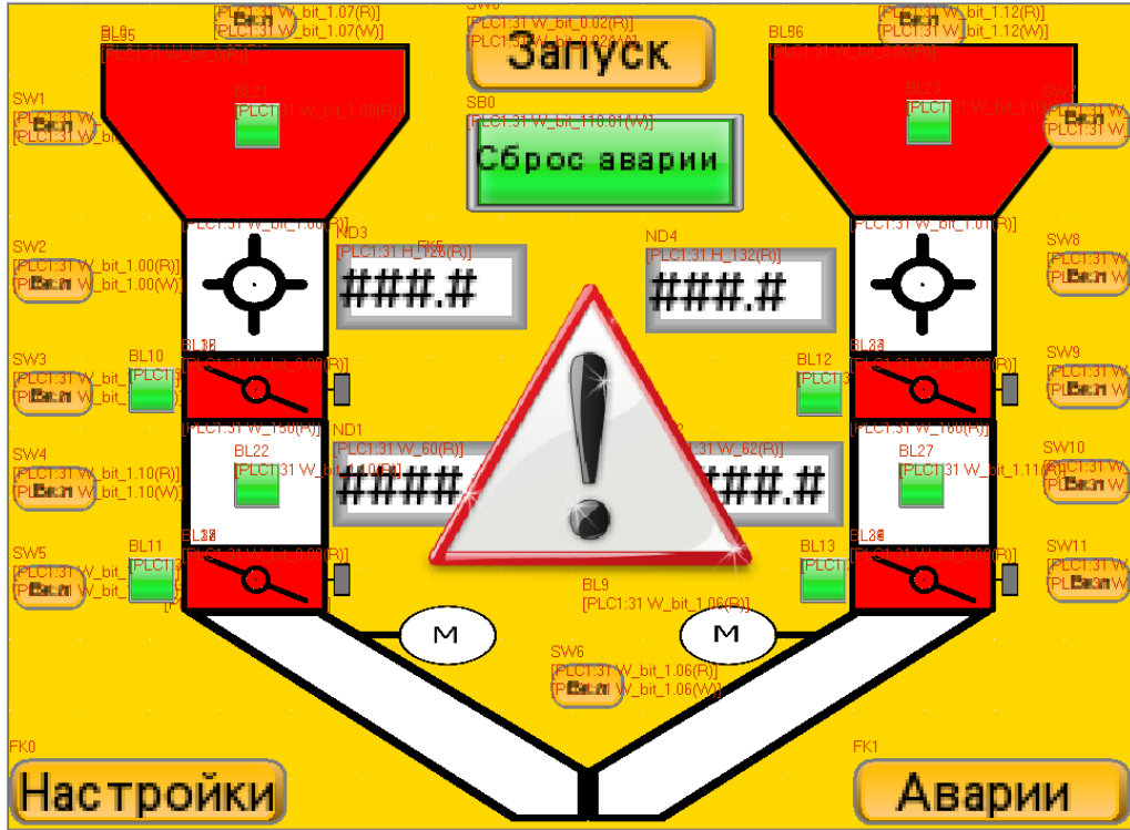
Рисунок 5.13 – Экран при возникновении неисправности
