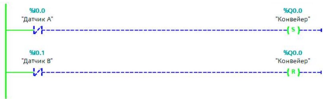
Рисунок 6.13 – Выход %Q0.0 остался активизированным
