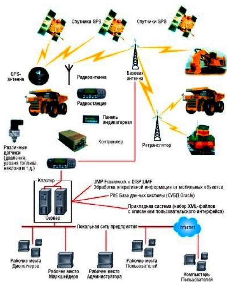
Рисунок 2.2 - Автоматизированная система планирования и учета транспортных перевозок и эксплуатации транспортных средств
