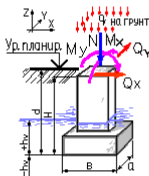
Рисунок 2.2 Схема нагружки на столбчатый фундамент.
