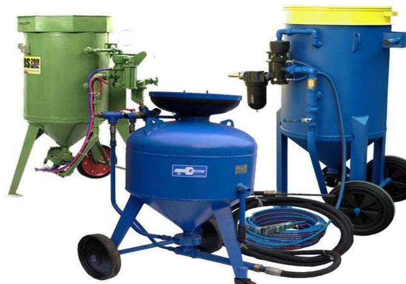
Рисунок 3.4 - Оборудование для пескоструйной обработки и покраски
