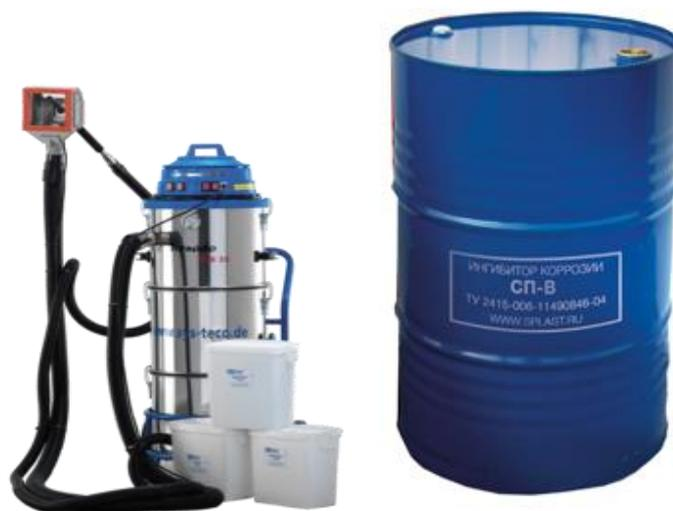
Рисунок 3.3 – Оборудование для покрытия антикоррозийной мастики и ингибитор коррозии.
