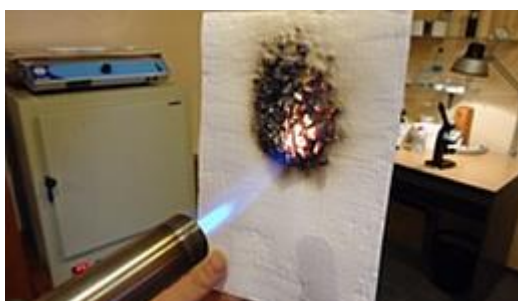
Рисунок 3.8 – Пять минут воздействия горелки на картон
