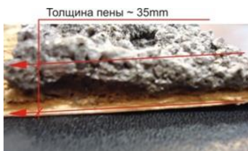
Рисунок 3.4 - Картон под слоем RE-FLAME
