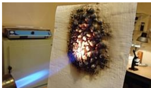
Рисунок 3.9 – 20 минут воздействия горелки на картон
