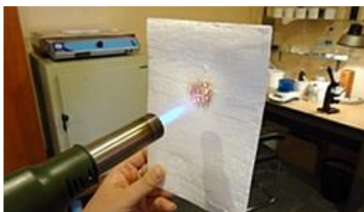
Рисунок 3.7 – Одна минута воздействия горелки на картон
