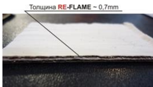
Рисунок 3.3 - Покрытие RE-FLAME (средняя толщина слоя 0,7мм) нанесенное на лист гофрокартона (толщина картона 2,5мм)
