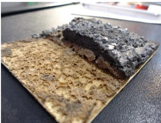
Рисунок 3.2 - Слой пены, образованный путем воздействия пламени на покрытие RE-FLAME толщиной 0,7мм.
