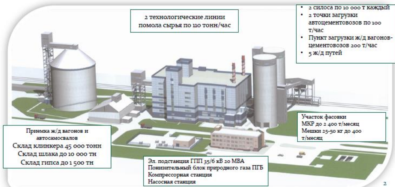
Рисунок 4 – Помольно-смесительный комплекс ООО «Мечел-Материалы»
