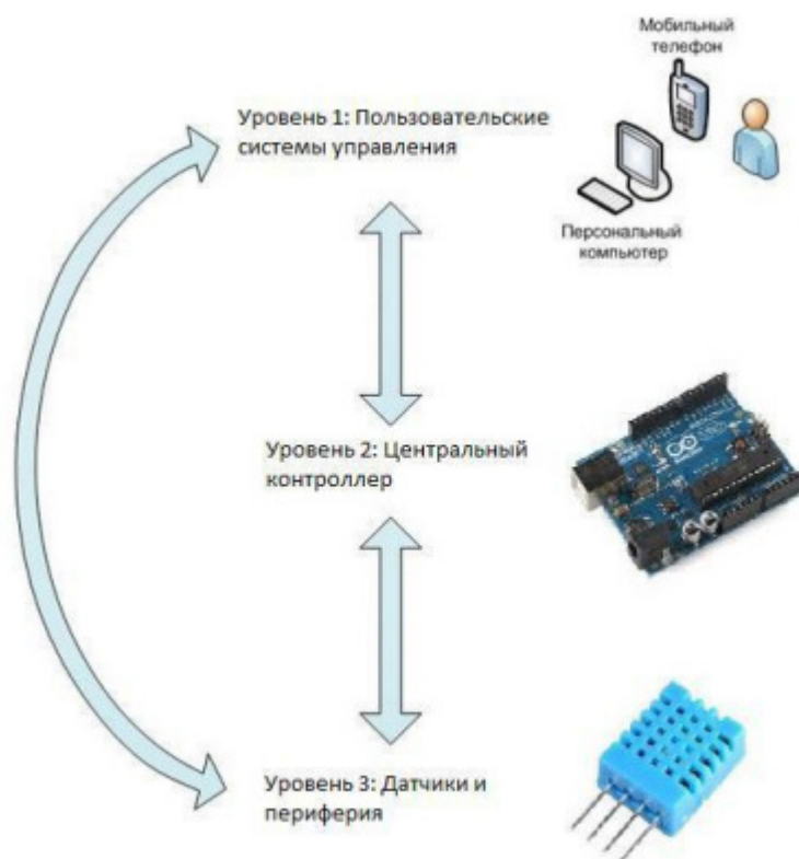
Рисунок 5 – Архитектура системы управления.
