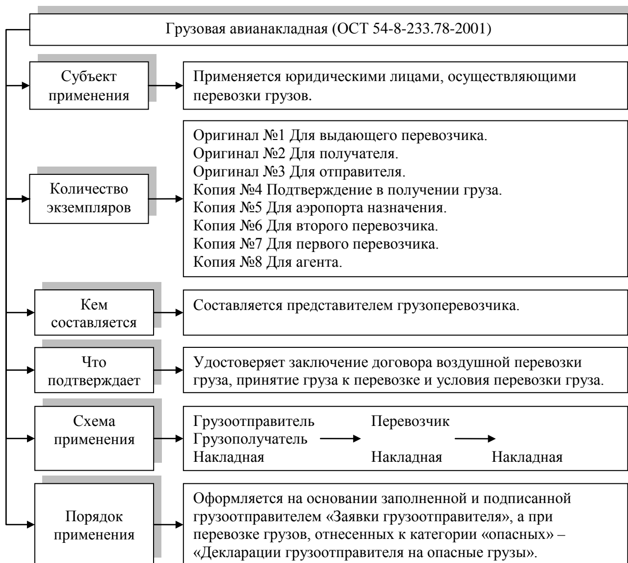
Рисунок 2 – Содержание грузовой авианакладной (ОСТ 54-8-233.78-2001)
