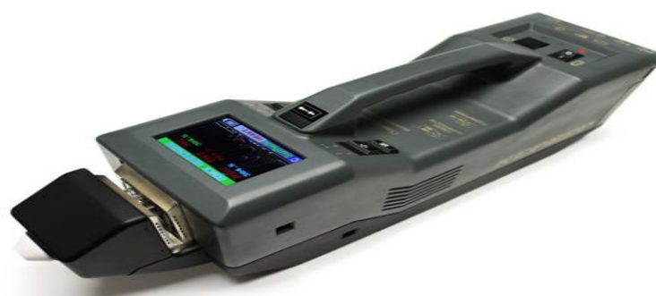
Рисунок 6 – Ионно–дрейфовый детектор «Кербер»
