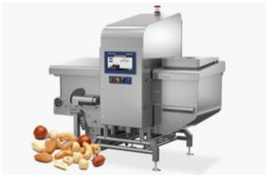
Рисунок 4.2 – Система рентгеновского контроля для проверки нерасфасованных пищевых продуктов
