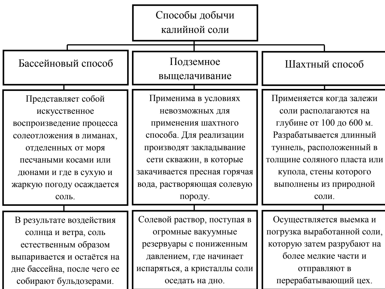
Рисунок 2.1 – Способы добычи калийной соли
