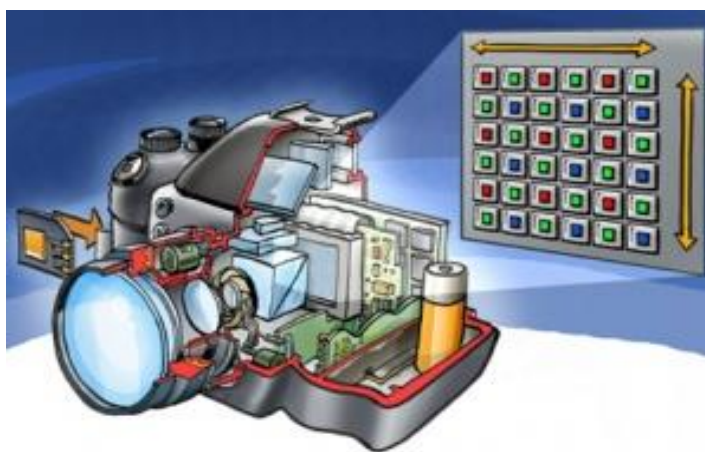
Рисунок 1.2 –Схема оцифровки изображения внутри фотокамеры
