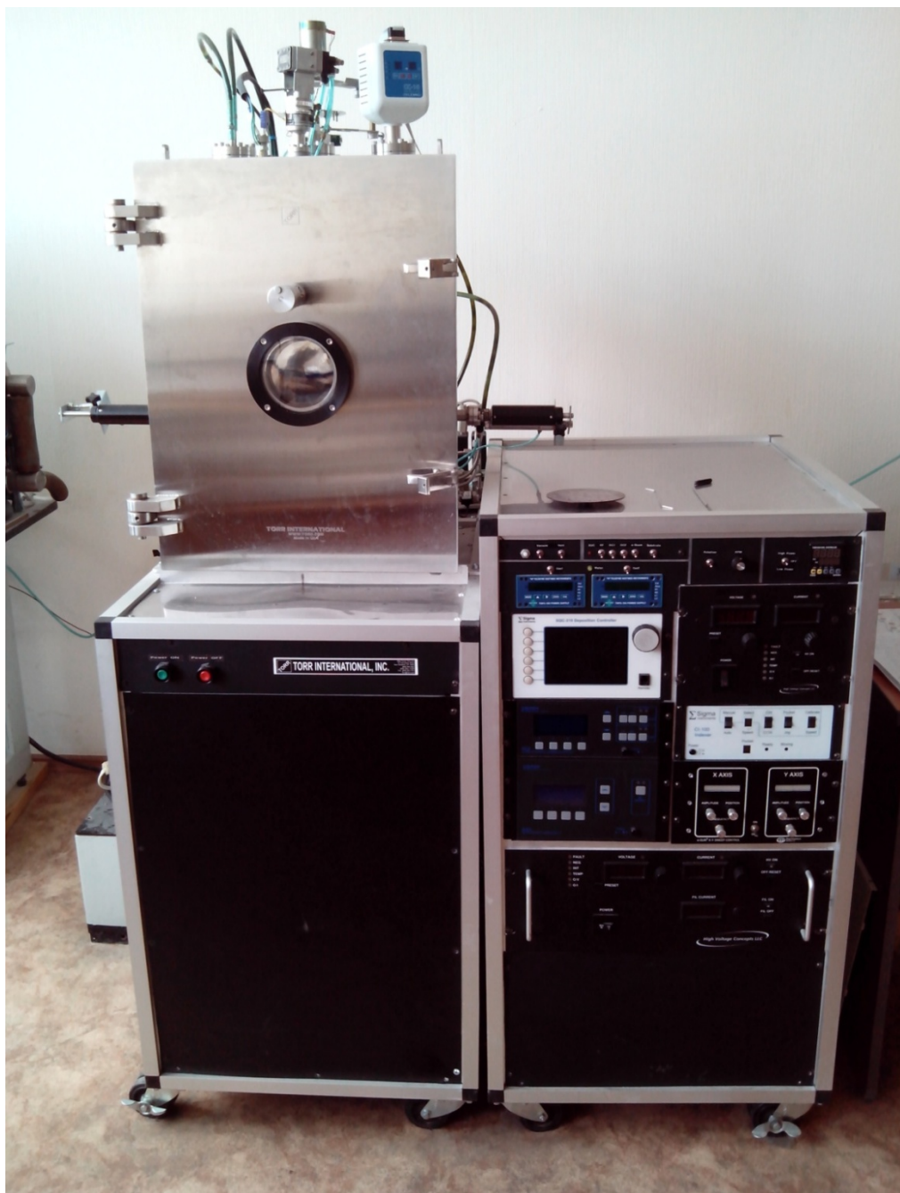
Рисунок 1. Комбинированная система электронно-лучевого и магнетронного распыления в вакууме «TORR500»
