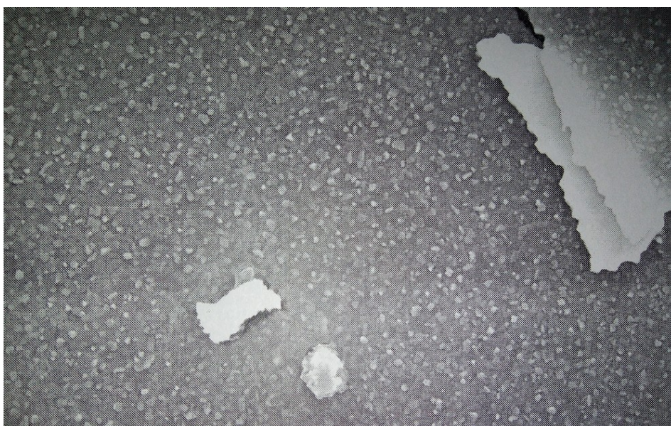
Рисунок 11. Дефекты и включения на поверхности пленки висмута
