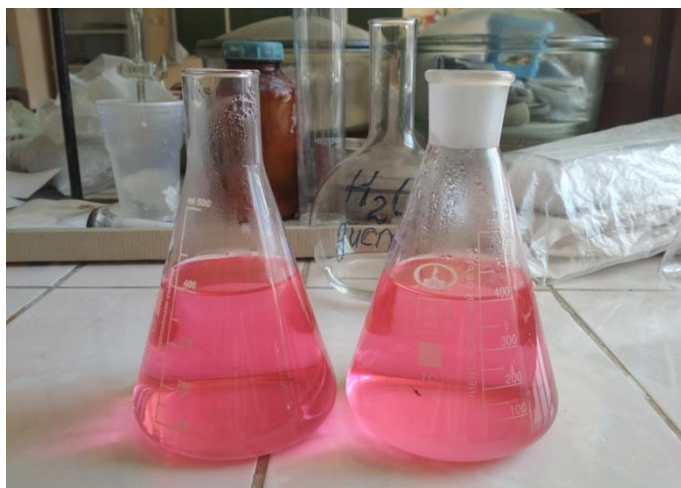
Рисунок 3.2 – Растворы содержимого тигля при добавлении 5%-ного раствора хлористого бария
