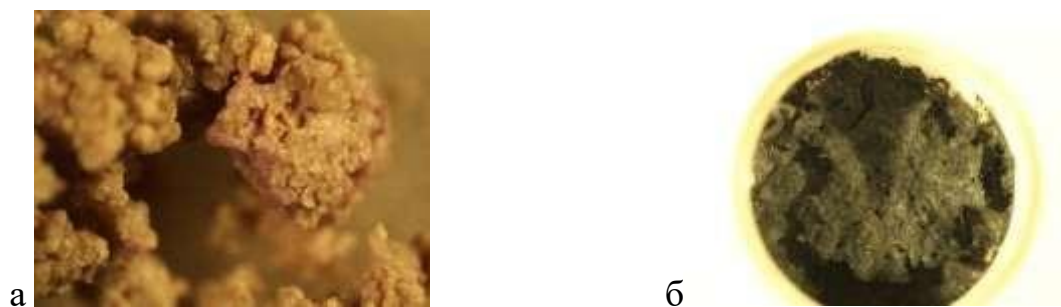
Рисунок 2.7 – Изображение бензоата кобальта до термоанализа (а) и после него (б) (размер фотографии а - 2х3 мм, б – 5х7 мм)
