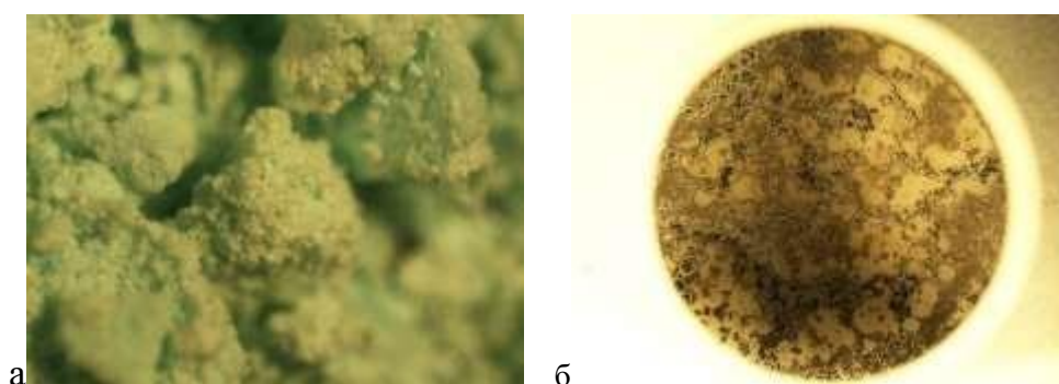
Рисунок 2.24 – Изображение бензоата никеля до термоанализа (а) и после него (б). Размер фотографии а – 2х3 мм, б – 5х7 мм
