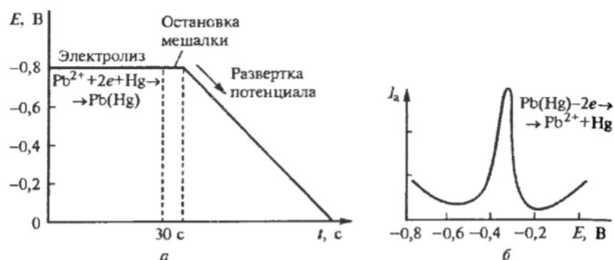
Рисунок 1.1 – Предварительный электролиз и развертка потенциала (а) и изменение тока (б) при регистрации анодной инверсионной вольтамперограммы на стационарном ртутном электроде
