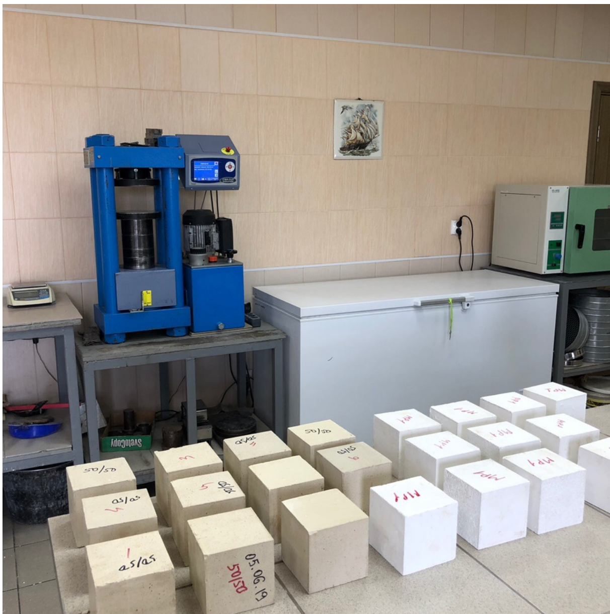
Рисунок N1 – образцы бетонных составов в лаборатории «ИнБетон»
