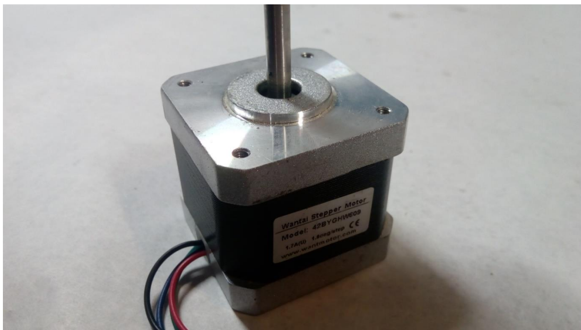
Рисунок 5. Шаговый двигатель: NEMA 17 42BYGHW609
