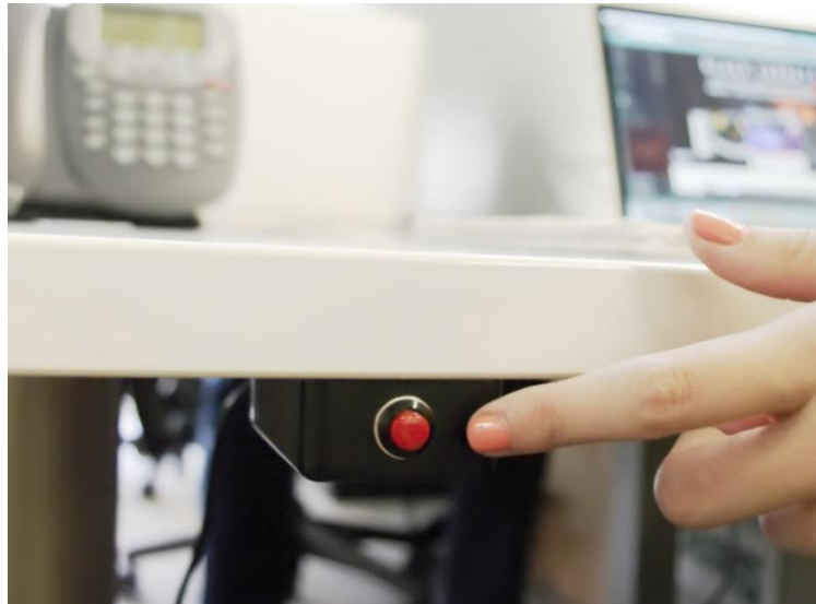
Рисунок 1.7.2 - Тревожная кнопка. Отличие тревожной сигнализации и охранной
