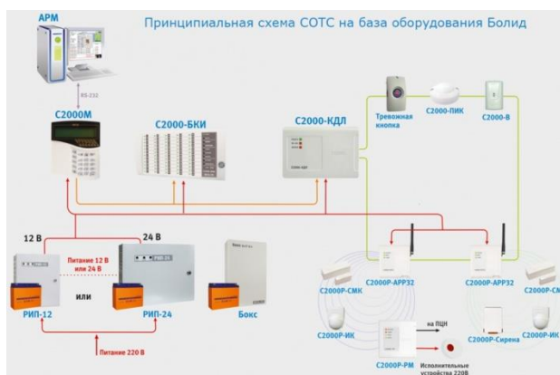
Рисунок 1.7.1 - Принципиальная схема СОТС на базе оборудования Bolid.
