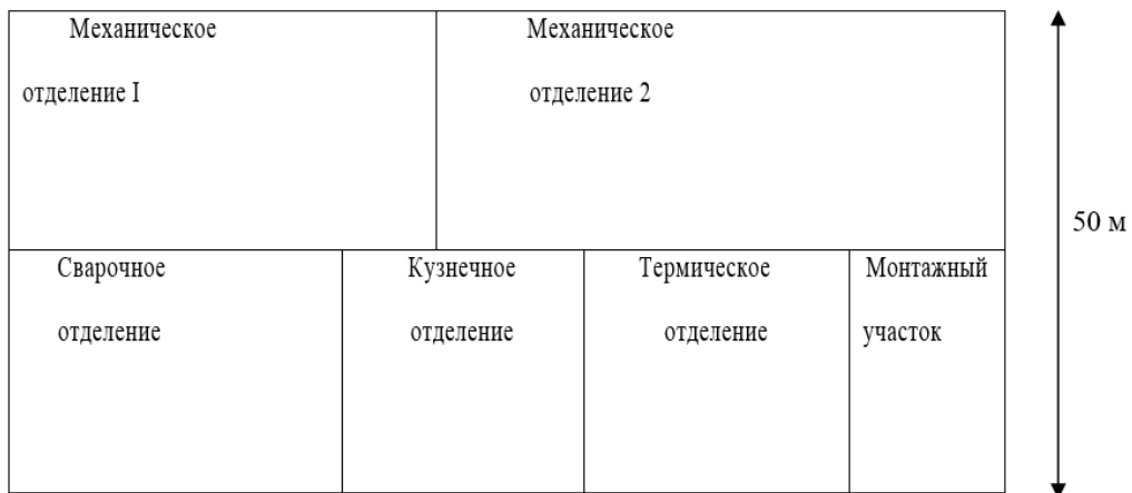
Рисунок 2 – План ремонтно-механического цеха №2
