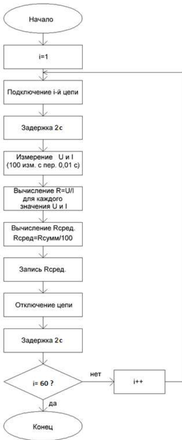
Рисунок 5.7 – Алгоритм проверки сопротивления цепей аппаратуры
