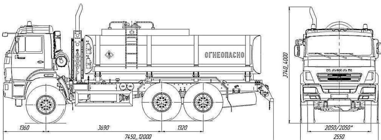
Рисунок 1 – Автотопливозаправщик УСТ-5453 на шасси КАМАЗ-43118
