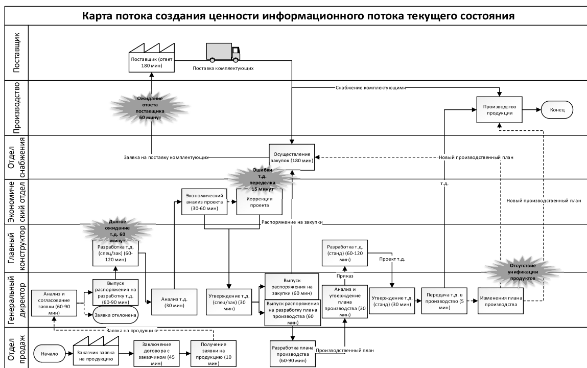
Рисунок 6 – Карта потока создания ценности для информационного потока текущего состояния созданная в программе MS Visio
