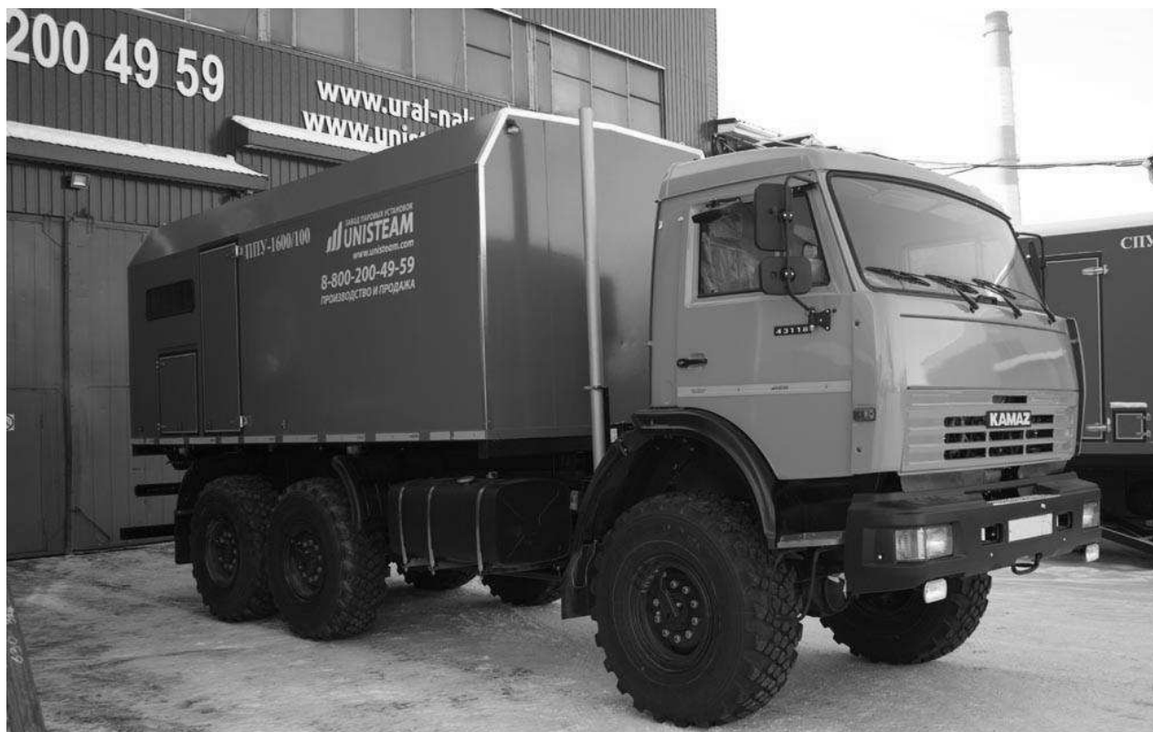
Рисунок 4 – Универсальная парогенераторная установка ППУА 1600/100 серии UNISTEAM – М
