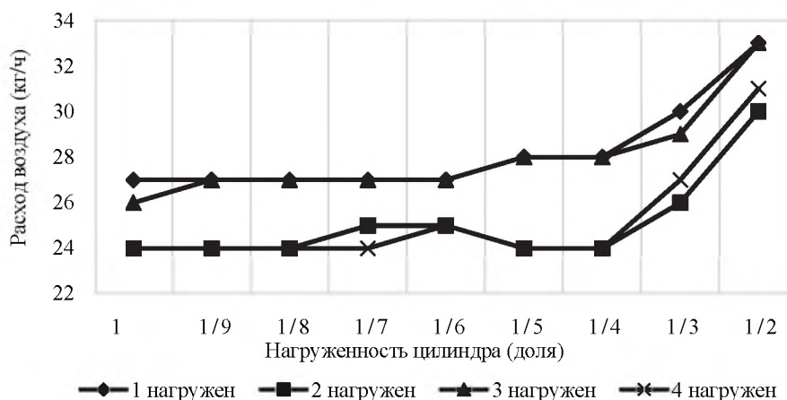
Рис. 5. График зависимости изменения расхода воздуха через РХХ (кг/ч) от степени нагруженности цилиндров (доли), включенных поочередно
