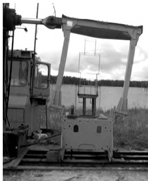
Рис. 9. Боковое нагружение ROPS
