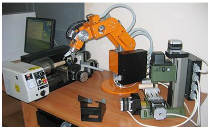
Рис. 2. Модель ГПМ на базе токарного и фрезерного станков с компьютерным управлением
