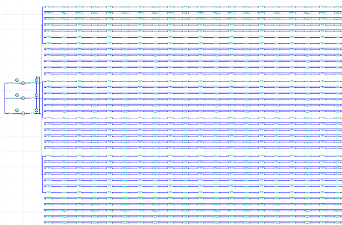
Рис.4. Электрическая схема якорной обмотки для проведения испытаний.
